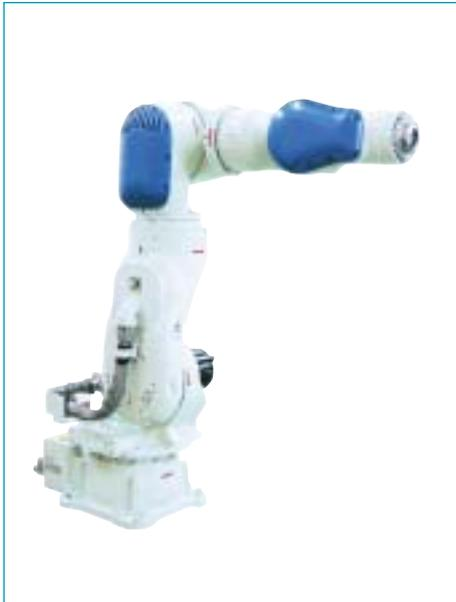
MOTOMAN-SIA50Dは、7軸の自由度を持ちながら、50 kgの重量物を扱うことができます。狭い場所における高重量のワークのハンドリングに最適です。
