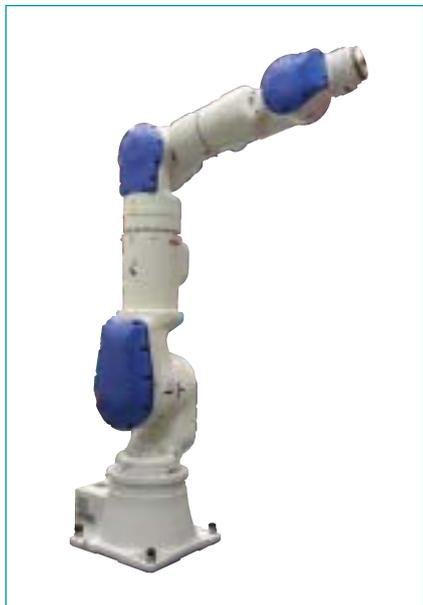
MOTOMAN-SIA30Dは、7軸の自由度を持つ30 kg可搬のロボットです。
