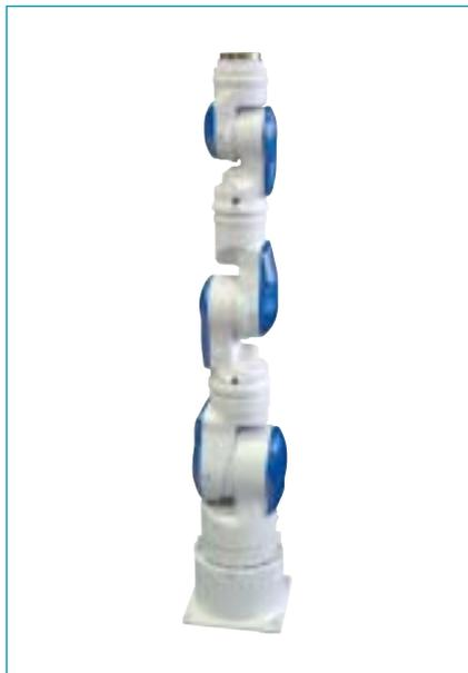
MOTOMAN-SIA10D/Fは7軸の自由度を持ちながら、SIA20D/Fよりもコンパクトなサイズの10 kg可搬ロボットです。狭い場所における小物ハンドリングなどに最適です。
