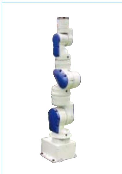
MOTOMAN-SIA5D/Fは7軸の自由度を持つ5 kg可搬のロボットです。
